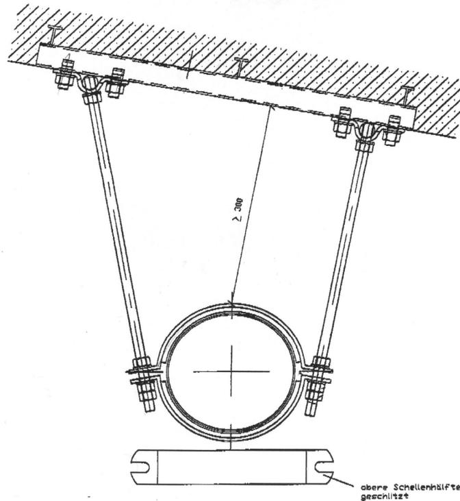
**HUC - Uni Rohraufhängung aus Edelstahl rostfrei mit Gummieinlage zum Andübeln oder zur Befestigung an Ankerschienen**
