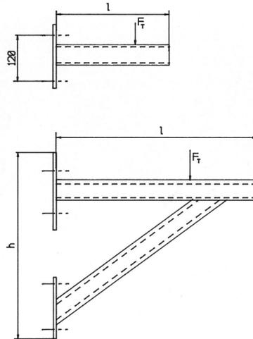
**Konsole** aus C - Profil zur Aufnahme von Rohrleitungen an Wänden,
