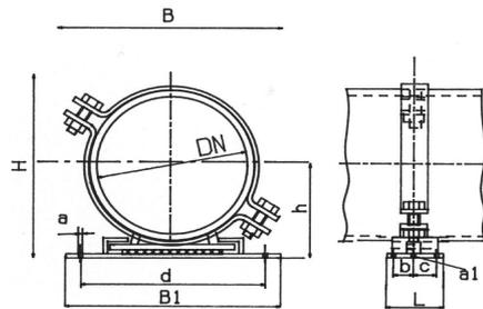
**Gleitlager** mit Abhebesicherung zum Andübeln oder zur Befestigung auf Konsolen, in Hängerahmen unter Brücken, für Heißluft-, Fernwärme, **WKG** - Rohre, bewegte Leitungen etc. mit Gleitblechen aus Edelstahl auf Spezialkunststoff, Reibungsbeiwert < 0,1 gem. statischem Erfordernis.
