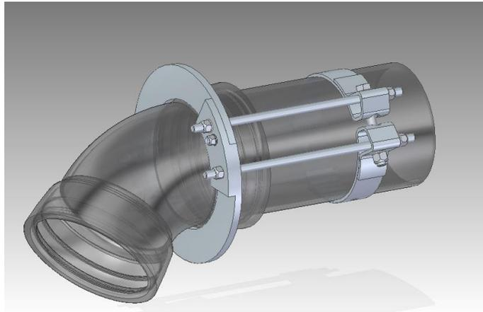
HUC - Schubsicherung "HUCKENBECK - STABIL" **Ausführung 4**, mit je 4 Zugstangen für Formstücke aus duktilem Gußeisen (MMK-, MMQ-, MMA-, MMB- Stücken), komplett mit verzinkten Schraubverbindungen und Bitumenanstrich, einbaufertig.
