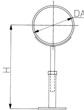
**Rohrstütze** mit Drittelschale und elastischer Einlage,
