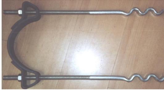
**Halbschelle "HUCKENBECK STABIL"** mit je 2 Steinschrauben und 2 Muttern, komplett mit verzinkten Schraubverbindungen und Bitumenanstrich, einbaufertig, zum Befestigen von Rohren auf Betonsockeln.
