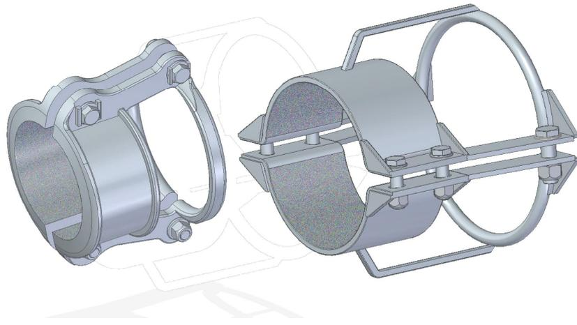
HUC - Auszugsicherung aus Stahl S 355 oder GGG. Epoxidharz-Pulverbeschichtet  $\geq 250 \mu\text{m}$ , für PVC Rohre und Formstücke, Schelle für Einsteckende innen Korrosionsbeschichtet.
