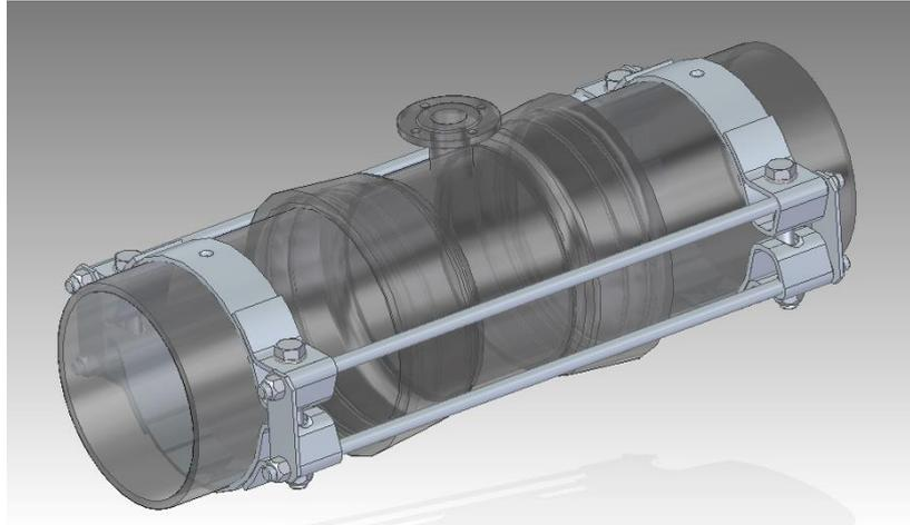
HUC - Schubsicherung "HUCKENBECK - STABIL" **Ausführung 6**, mit je 4 Zugstangen für Formstücke aus duktilem Gußeisen, komplett mit verzinkten Schraubverbindungen und Bitumenanstrich, **einbaufertig für U- und MMA- Stücke.**
