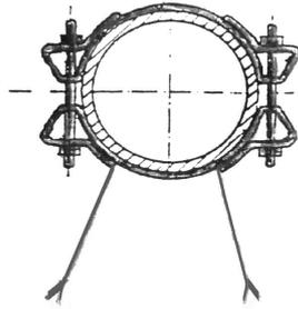
**Haltekonsole/Ortsbetonschelle** zur Befestigung von Rohren und Schiebern auf Beton für Prüfdruck bis 16 bar.
