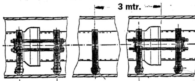
HUC - Schubsicherung "HUCKENBECK STABIL" **Ausführung 3**, mit je 4 Rollen (Achsen und Rollen aus nicht rostendem Material) zum Einführen, Lagern sowie gleichzeitigem Schubsichern eines Mediumrohres im Schutzrohr; Schraubverbindungen verzinkt, ansonsten bituminiert, mit Abstützung nach oben, einbaufertig
