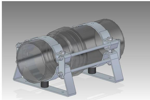
HUC - Schubsicherung "HUCKENBECK - STABIL" **Ausführung 7**, mit je 4 Zugstangen für gerade Rohrstrecke komplett mit verzinkten Schraubverbindungen und Bitumenanstrich zur gleichzeitigen Aufständigung auf Beton, einbaufertig.
